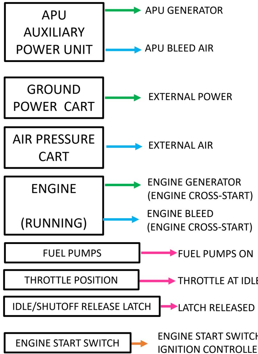
IGNITION CONTROLLED BY FADEC (FULL AUTHORITY DIGITAL ENGINE CONTROLLER)
