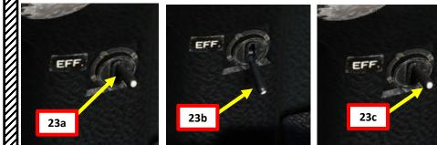
Radar Telemeter (TEL, Télémétrie) / Area Zone Scanning (BPZ, Balayage par Zone) Selector Switch
