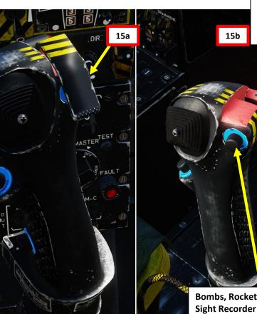
Gun Firing Trigger (Commande Enregistreur de Visée et de Tirs Canons) • Folded: RSHIFT+SPACE • Unfolded (as shown): RCTRL+SPACE
