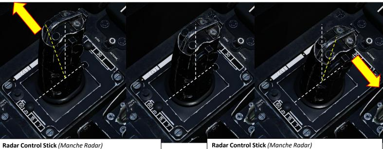
• Rolling Right: Moves radar alidade/strobe bearing right
