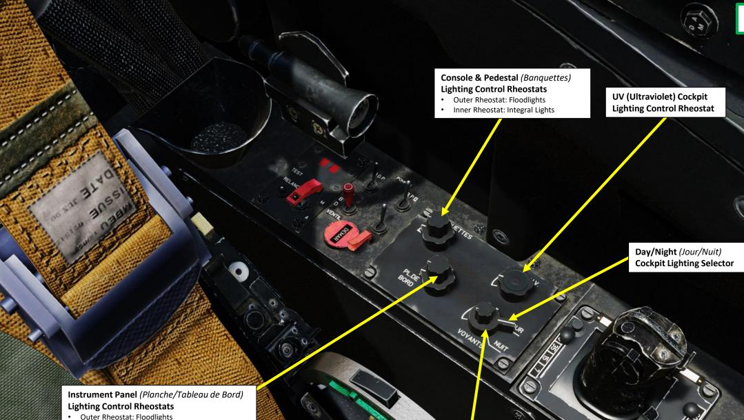
Outer Rheostat: Floodlights • Inner Rheostat: Integral Lights
