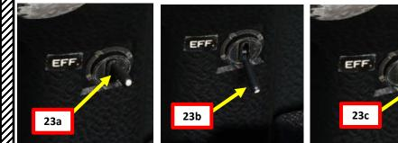
Radar Telemeter (TEL, Télémétrie) / Area Zone Scanning (BPZ, Balayage par Zone) Selector Switch
