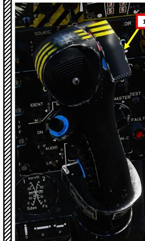
**Gun Firing Trigger** (Commande Enregistreur de Visée et de Tirs Canons) • Folded: RSHIFT+SPACE Unfolded (as shown): RCTRL+SPACE
