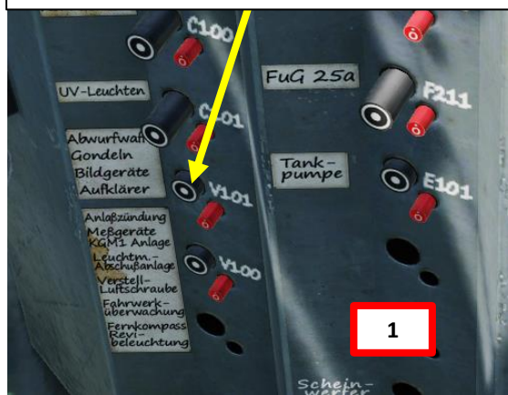
V101 External Ordnance and Optional Equipment Power Switch ( Abwurfwaffe Gondeln Bildgeräte Aufklärer )
