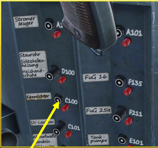
C100 Navigation Lights Power Switch (Kennlichter)
